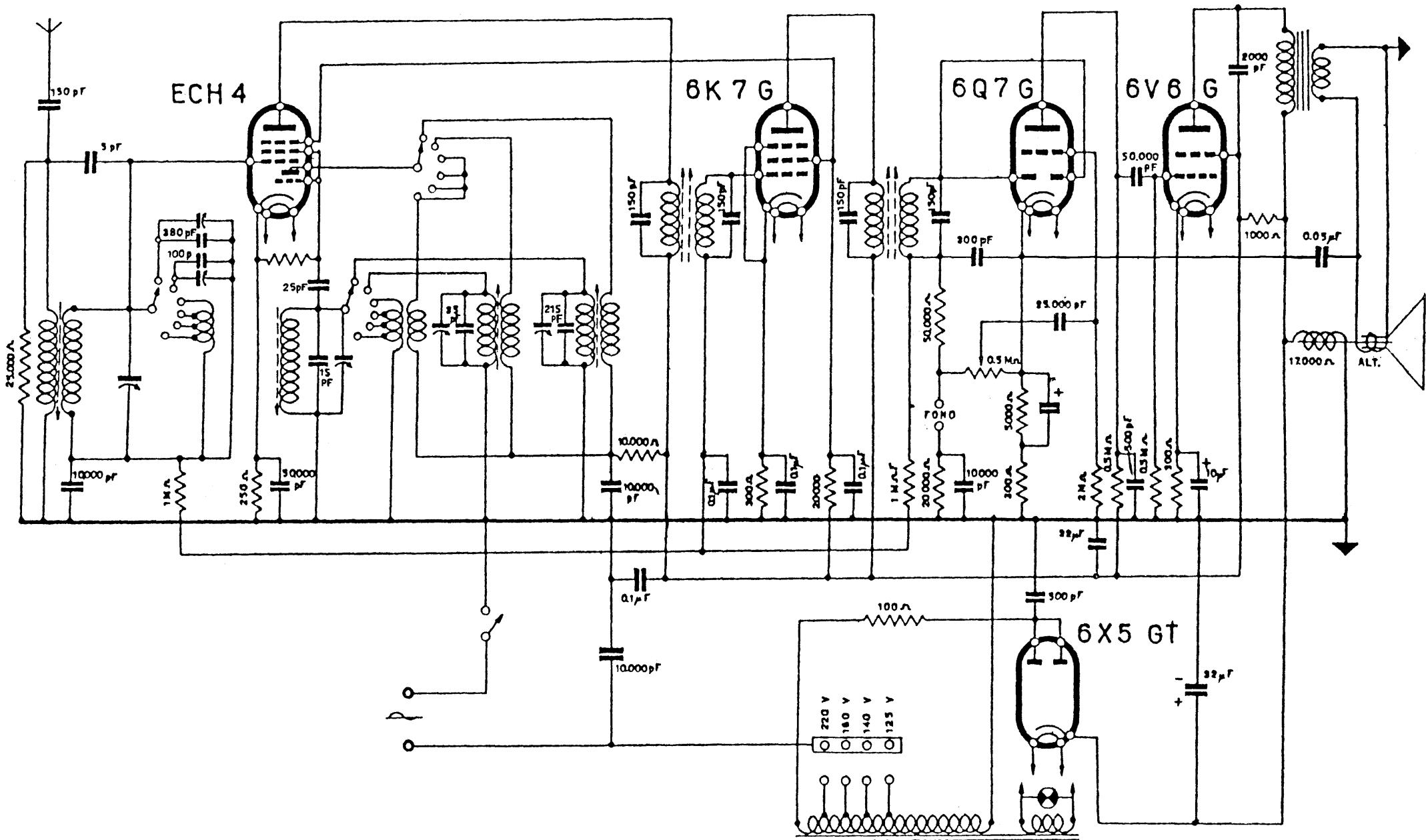
3 - ALLOCCHIO, BACCHINI e C. - MOD. 526. Supereterodina con sintonia a permeabilità (senza condensatore variabile). Gamma onde medie suddivisa in due parti (da 195 a 350 m e da 350 a 570 m). Quattro campi onde corte: a 49, a 41, a 31 e a 25 m. Produzione 1946..
